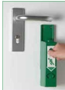
Mit dem Geräteschlüssel kann der Türwächter durch Verschieben nach unten alarmfrei in eine Dauerfreigabeposition gebracht werden. In dieser Stellung ist die Tür normal zu begehen. Ein Daueroffenkontakt ist auf Wunsch möglich.
