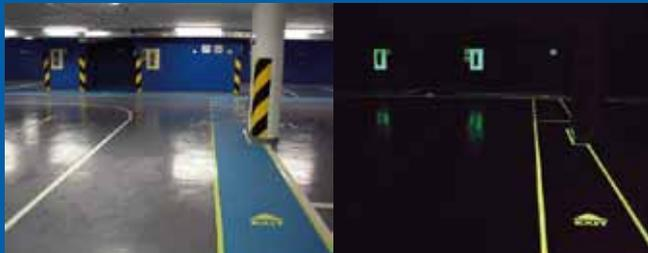
**System F** ist ein lösemittelfreies 2 - Komponenten - Epoxydharzsystem, vorzugsweise zur Flächenmarkierung und für Linien. Zur Erhöhung der Lagerstabilität erhalten Sie das Leuchtpigment in einem separaten Gefäß. Das Material kann gerollt oder auch gespachtelt werden.
