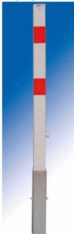
Der **Absperrpfosten** besteht aus einem verzinkten, weiß pulverbeschichteten 70 x 70 mm Vierkantrohr mit zwei roten Signalstreifen und ist in unterschiedlichen Ausführungen lieferbar. Bei einer Gesamtlänge von 1400 mm steht er 1000 mm hoch über dem Erdreich. Sein Gewicht beträgt 9,5 kg.
